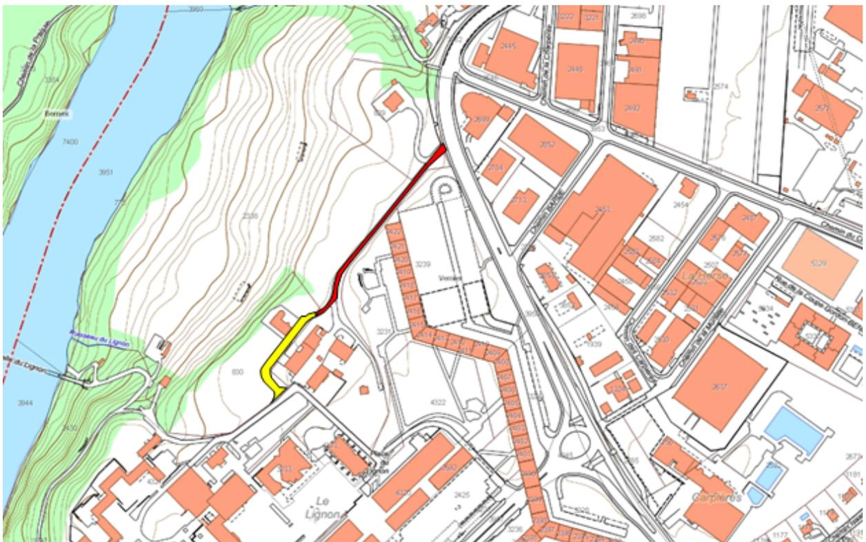
Néanmoins, la structure actuelle du chemin existant, allant de la route du Bois-des-Frères jusqu'en limite de notre parcelle No 830 ne permet pas de supporter le passage des véhicules lourds sans le détériorer, et une reprise de la fondation et du gabarit est nécessaire.
