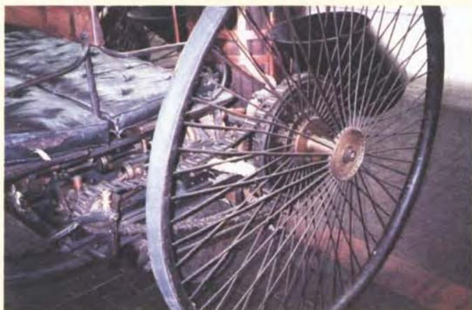
*Sous les sièges, le moteur et la chaîne*
