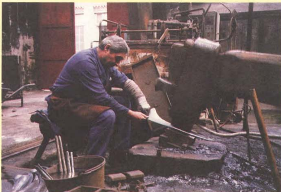
Pont-Salomon: on forme la lame au martinet
