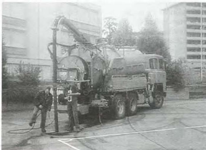
les employés de la Voirie. Effectivement, on dénombre annuellement environ 1 900 heures d'employés et 950 heures de camion-citerne équipé des appareils de curage nécessaires au nettoyage des canalisations et des sacs d'eaux pluviales dessous et le long de nos routes, ce qui représente une charge d'environ Fr. 190 000.- par année.
