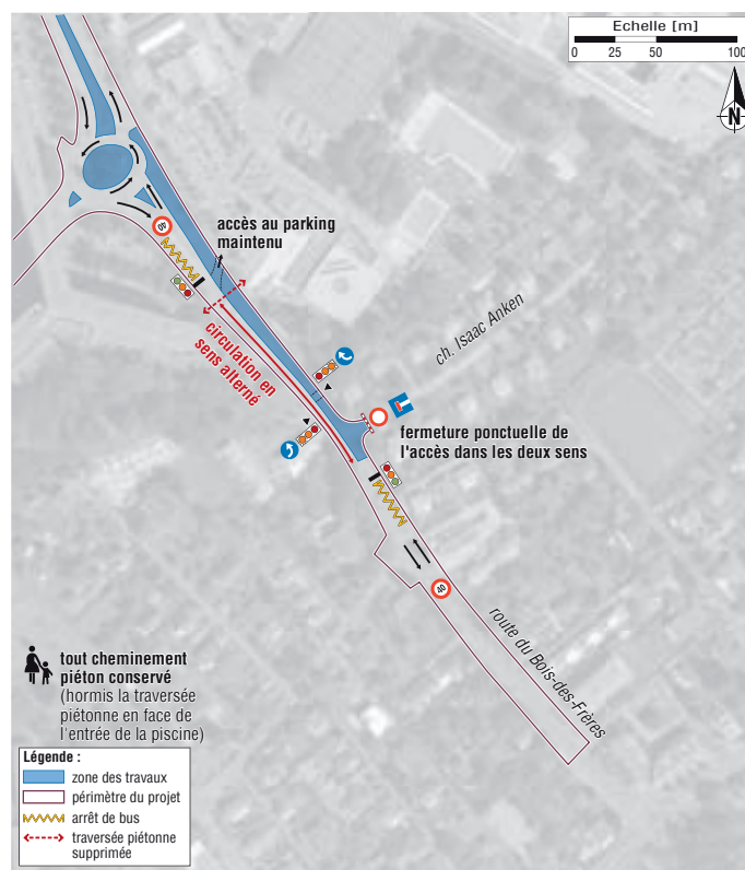
Gestion du trafic prévue sur Bois-des-Frères sud, avril-mai 2015.
